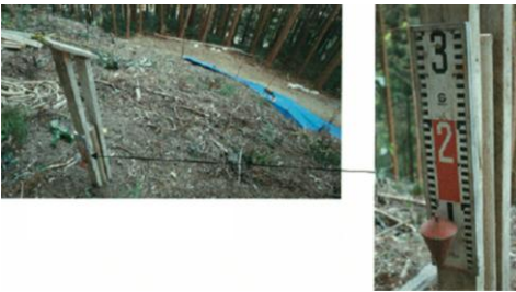
Slika 17 - Praćenje pomaka površine terena uz korištenje jednostavnog ekstenzometra
