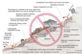
Slika 10 - Primjeri loših praksi gradnje na kosini (Australijsko geomehničko udruženje 2007.)
