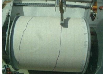
Slika 19 - Praćenje pomaka površine terena korištenjem analognog ekstenzometra
